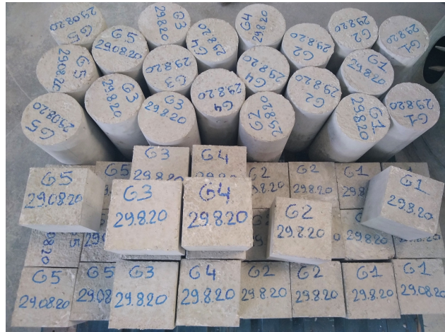
FIGURE 4.2 – Exemples d'éprouvettes cubiques et cylindriques pour la caractérisation du béton de la deuxième campagne
