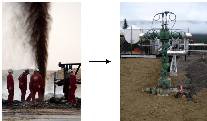
Figure 1.2 : Jaillissement de pétrole suite au forage (à gauche) et agencement d'un "Arbre de Noël" en tête de puits de pétrole (à droite)
