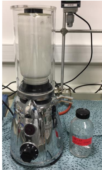
Figure 5.12 : Mixeur utilisé pour les tests de cisaillements sévères (Broyeur à couteaux, MICROTRON® MB 550)
