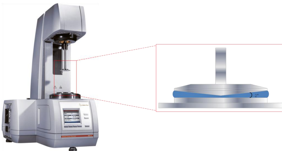
Figure 4.2 : Rhéomètre (MCR-302) et géométrie (CP50-2/S) utilisés pour les mesures rhéologiques des formulations
