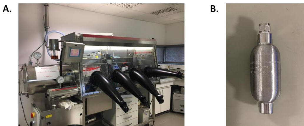
Figure 5.1 : A. Boîte à gant permettant de garder les formulations en conditions anaérobies. B. Capacité de 50mL contenant les formulations pour leurs mises en vieillissement
