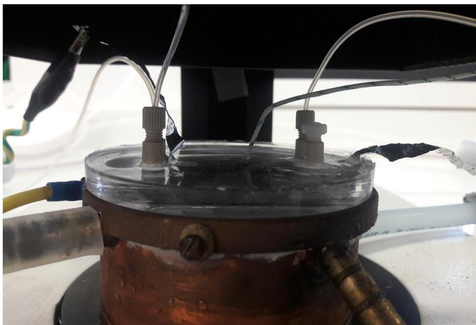
Figure 135 : Photographie du microréacteur BiFlow 2.7 avec électrodes ITO/Au posé sur le refroidisseur
