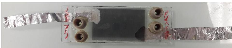
Figure 122 : Photographie d'un microréacteur BiFlow 2.7 avec bandes d'aluminium connectées aux électrodes ITO/Au au moyen de pâte d'argent et de ruban adhésif
