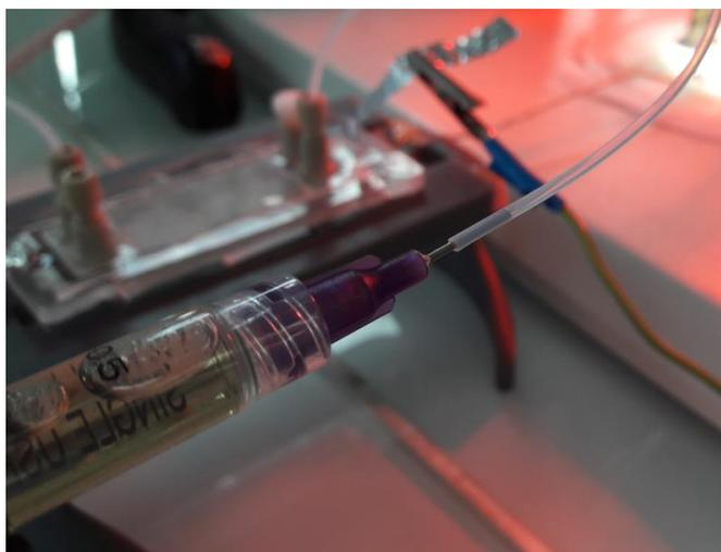
Figure 59: Photographie de la seringue avec l'embout en PP avec pointe émoussée insérée dans le tube 1/16'' en PTFE
