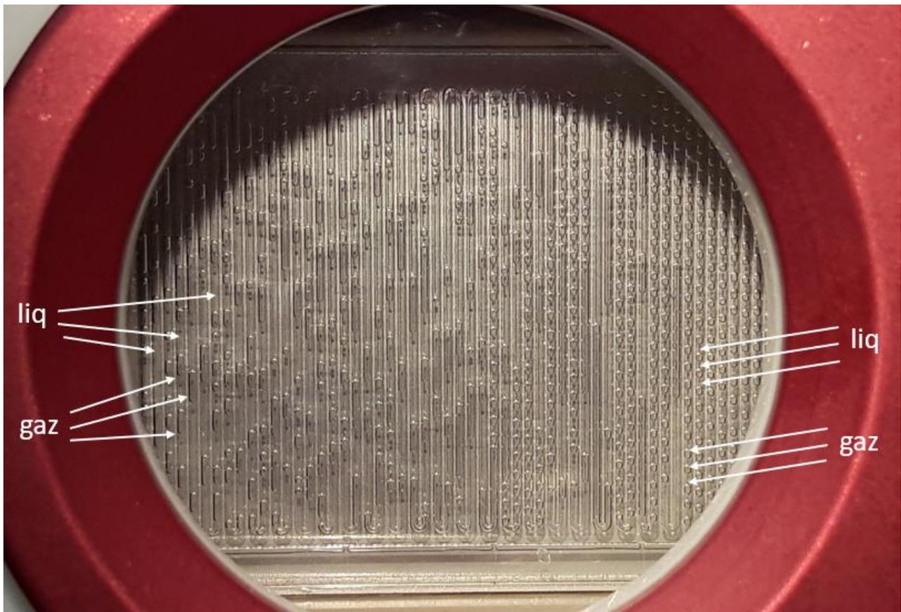
Figure 41: Photographie de la fenêtre du Asia Chip Climate Controller dans lequel est inséré le microréacteur Syrris 250  $\mu\text{L}$ , où l'on peut voir les slugs de gaz dans le liquide
