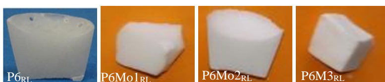
Figure A14.4 : Photos des échantillons refroidis lentement de la série P6Mox (x : %mass en MoO 3 ).
