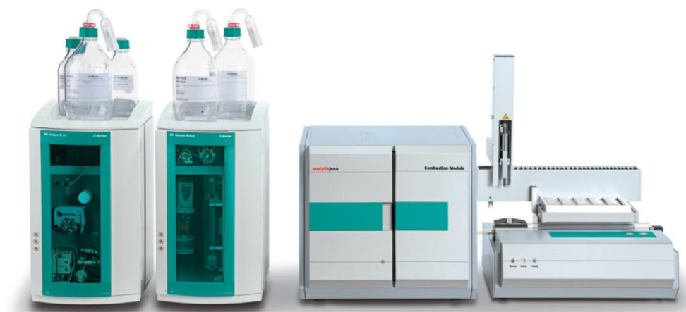
Figure II-5. Photographie du couplage C-IC (Metrohm, Villebon-sur-Yvette, France)
