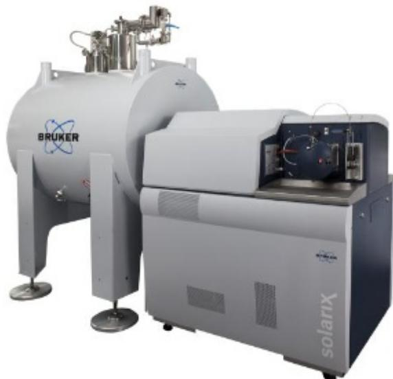
**Figure II-9.** Photographie du spectromètre de masse FT-ICR SolariX XR 9.4 T (Bruker Daltonik GmbH, Bremen, Allemagne)
