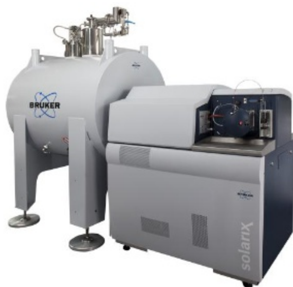
Figure II-9. Photographie du spectromètre de masse FT-ICR SolariX XR 9.4 T (Bruker Daltonik GmbH, Bremen, Allemagne)
