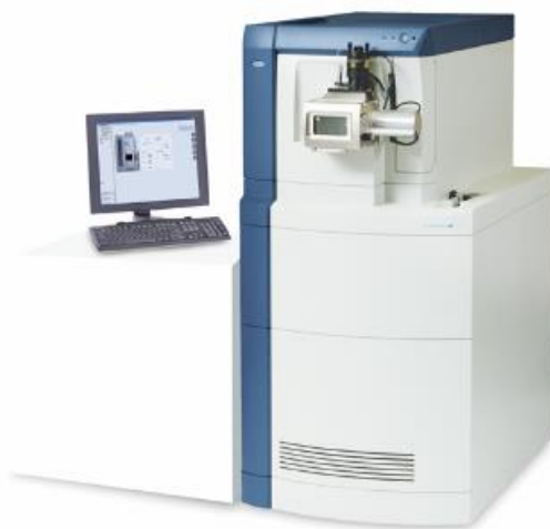
Figure II-8. Photographie du système Q-TOF utilisé
