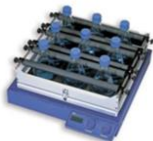
Figure II-3. Table d'agitation orbitale utilisée durant l'étape d'adsorption des SPOX sur charbon actif
