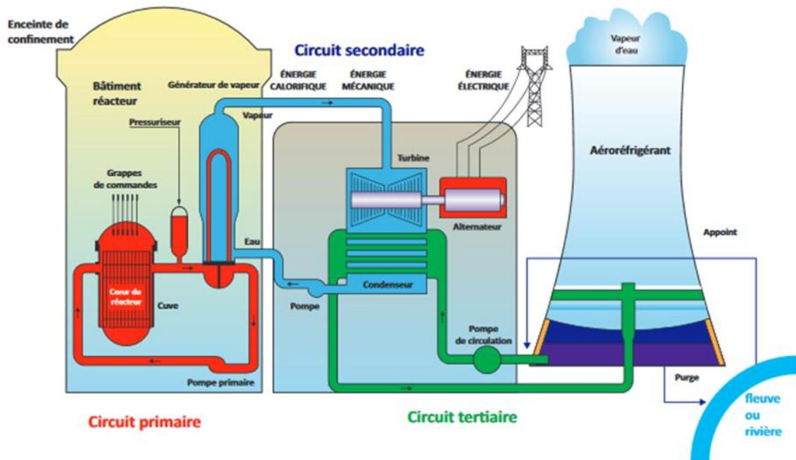
**Figure I-1.** Schéma représentatif du fonctionnement d'une CNPE et du point d'injection de la monochloramine (en amont du condenseur, juste avant la pompe de circulation – circuit de refroidissement tertiaire en couleur verte).
