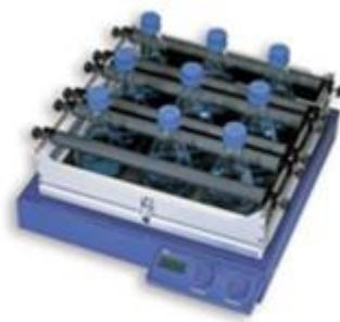
**Figure II-3.** Table d'agitation orbitale utilisée durant l'étape d'adsorption des SPOX sur charbon actif
