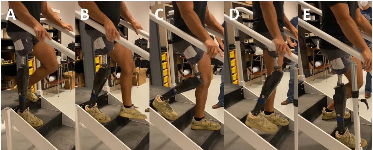
Figure 26 : marche en descente d'escaliers avec le prototype SYNSYS.
