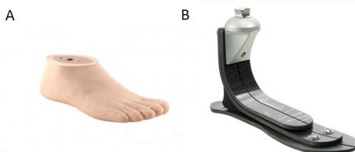
Figure 8 : exemples de pieds prothétiques disponibles. A - pied SACH : pied avec un noyau en bois entouré d'un matériau souple. B - pied ESR : lame en carbone permettant d'emmagasiner de l'énergie et de la restituer lors de la phase de propulsion. Une enveloppe souple (non représentée) permet de donner à la lame une forme similaire à un pied. Images fournies par Proteor™
