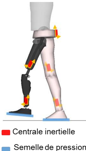
Figure 54 : placement des capteurs pour l'obtention du BCoM avec les centrales inertielles
