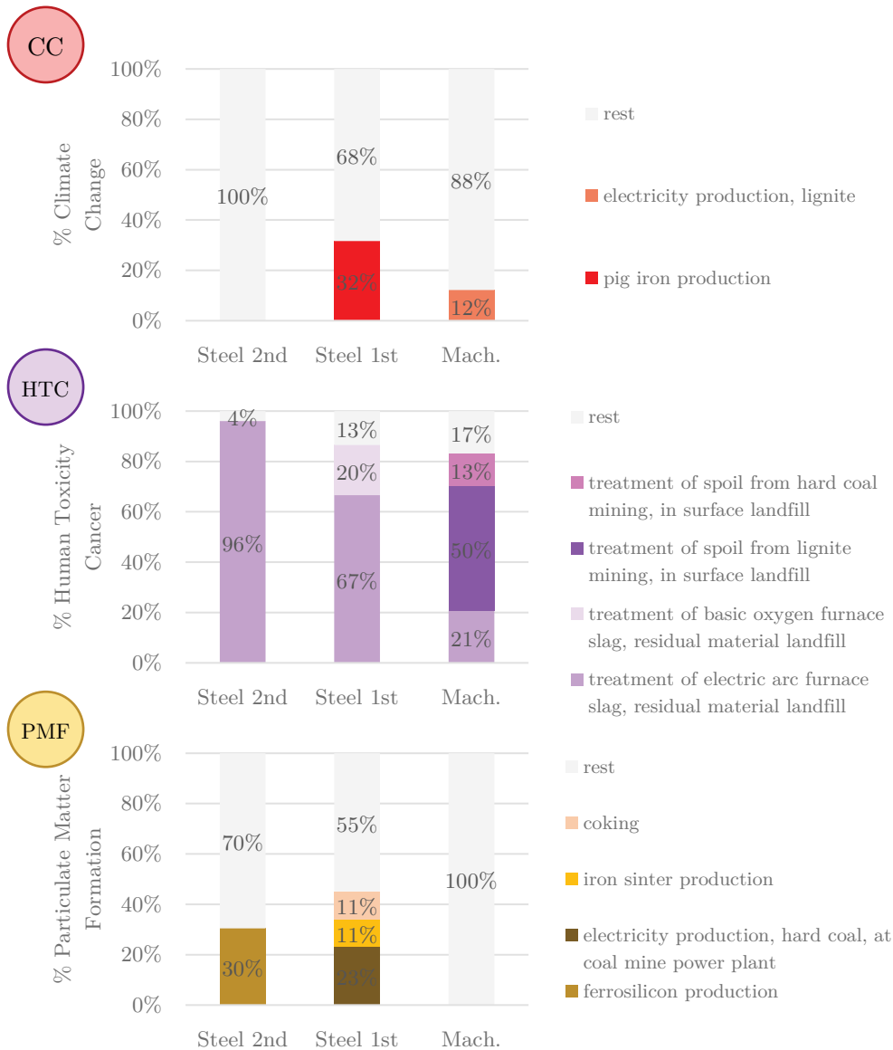
Figure 2-12 Analyse de contribution des sous-procédés à l'impact total des procédés élémentaires de production de l'acier et d'usinage du bois. Seuls les sous-procédés dont la contribution à l'impact total du procédé élémentaire est supérieure à 10% sont représentés.
