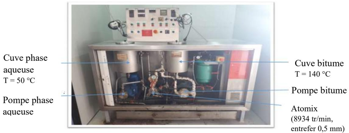
Figure 42. Moulin colloïdal de type Emulbitume®.
