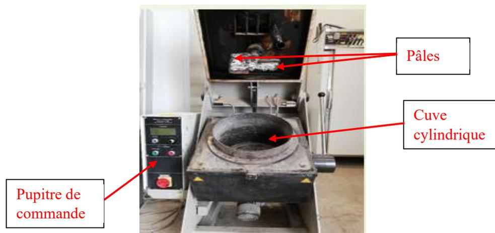
Figure 56. Malaxeur de capacité 30 kg (Laboratoire IRC)
