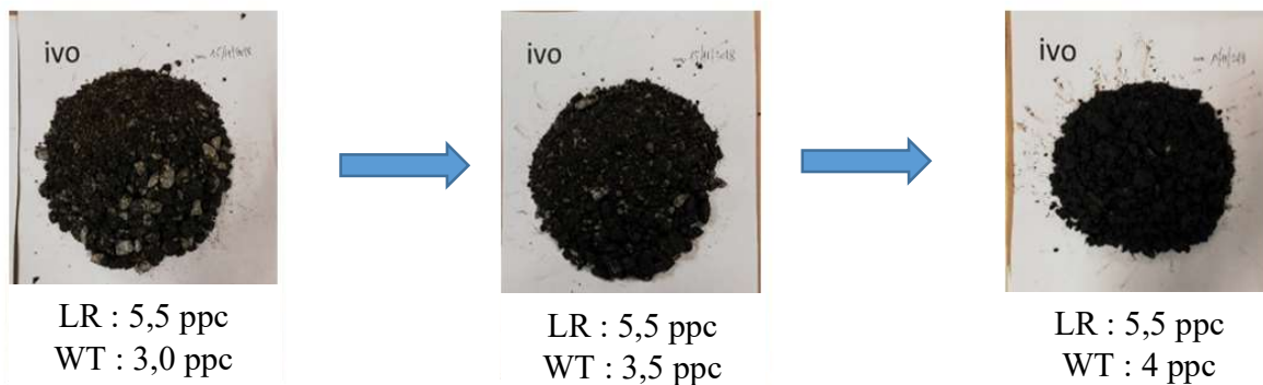
Figure 55. Etat de la qualité d'enrobage d'un mélange neuf de granite avec l'émulsion 1,5 % B à la teneur en liant résiduel (LR) de 5,5 ppc en variant la teneur en eau totale (WT) de 3 à 4 ppc.
