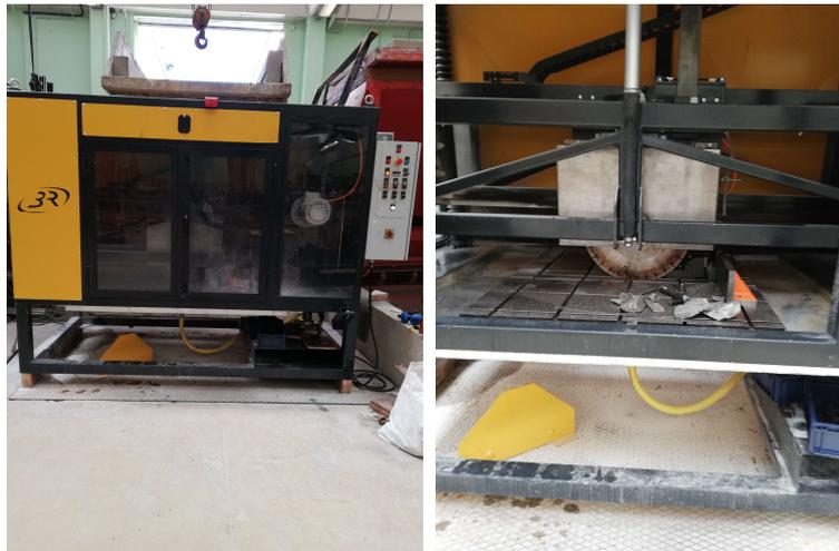
Figure 136. Scie ajusteuse du laboratoire de l'ENS Cachan.
