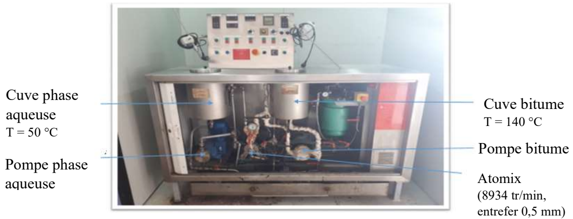
Figure 42. Moulin colloïdal de type Emulbitume®.
