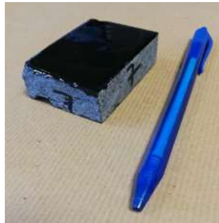
Figure 49. Cas d'un substrat de granite enrobé de liant bitumineux.
