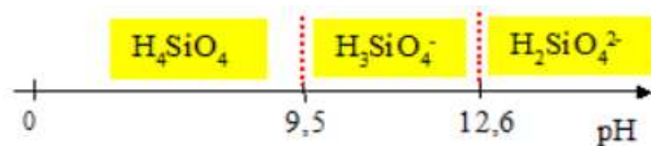
Figure 62. Diagramme de prédominance des différentes espèces acido-basiques de la silice dissoute [202].
