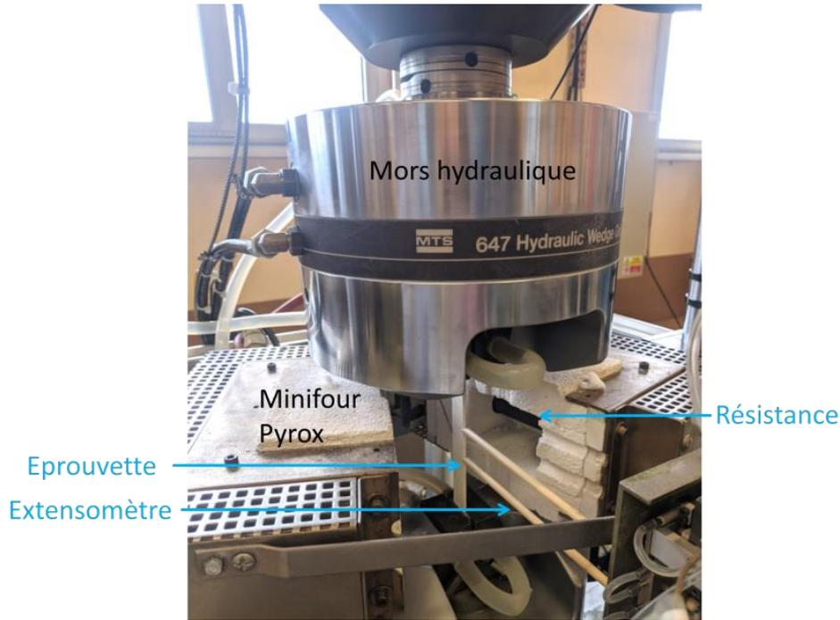
Figure 2.10 – Machine d'essais mécanique et minifour Pyrox 1700 °C
