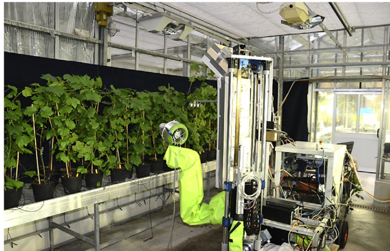
FIGURE 1.10 : Exemple de robot pulvérisateur. Source : [Oberti et al., 2016].
