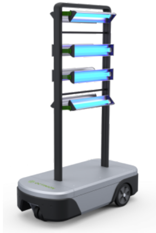
FIGURE 1.4 : Robot mobile développé par Octinion pour le projet UV-Robot
