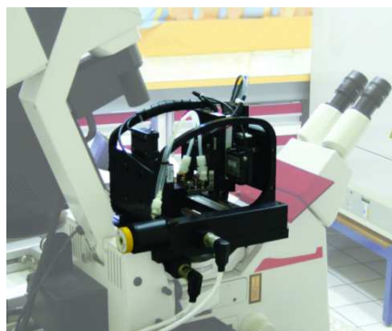
Figure 50 : Photographie de la cellule RheOptiCAD ® positionnée sur le microscope confocal (Boitte et al., 2013)
