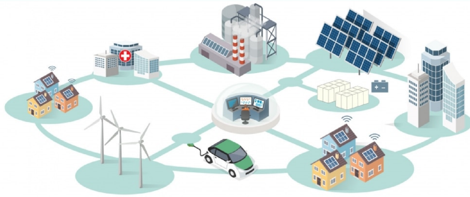
FIG. 4 – Schéma d'un microgrid regroupant producteurs, stockeurs et consommateurs [22]
