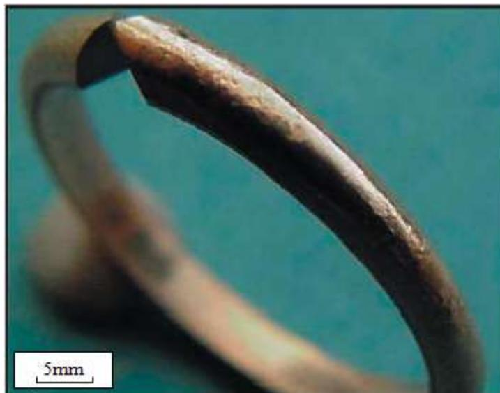
*FIGURE 29 : EXEMPLE D'EFFET PEAU D'ORANGE A LA SURFACE D'UN ANNEAU*
