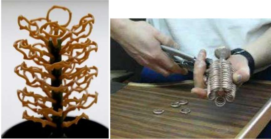
FIGURE 19 : EXEMPLE D'UNE GRAPPE DE PIÈCES EN OR RÉALISÉES EN MOULAGE EN CIRE PERDUE (PARTIE DE BAGUE « ROSE DIOR BAGUETTE » À GAUCHE) ET DEGRAPPAGE (À DROITE)<sup>[93]</sup>
