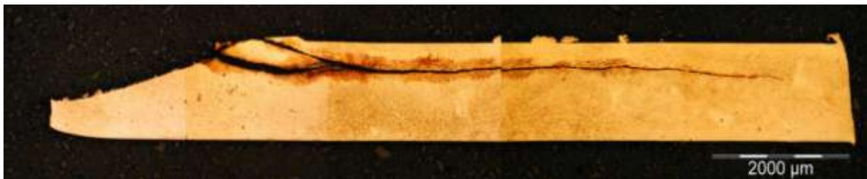
*FIGURE 78 : MICROGRAPHIE OBTENUE APRES ATTAQUE A L'EAU REGALE D'UNE PASTILLE DE POUDRE TAMISEE FRITTEE AVEC UN MONTAGE « QUATRE MURS »*
