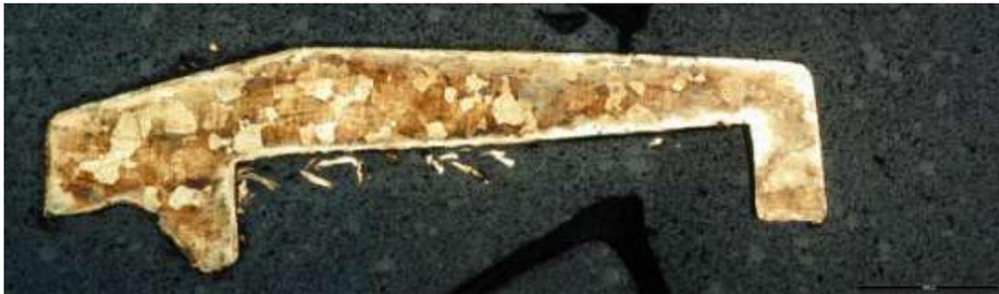
FIGURE 64 : MICROGRAPHIE OBTENUE APRES ATTAQUE A L'EAU REGALE D'UNE PIECE (POUDRE CLASSIFIEE) FRITTEE SELON LE CYCLE DE REFERENCE COMPLET MAIS SOUS UN DEBIT DE 2,5ML/S D'HYDROGENE PUR
