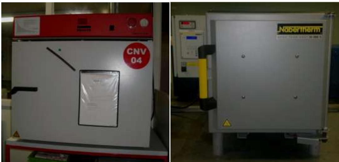
FIGURE 38 : ETUVE VENTILEE DE LA SOCIETE ALLIANCE (A GAUCHE) ET DE L'ECAM (A DROITE) UTILISEES POUR LE DELIANTAGE DES PIÈCES
