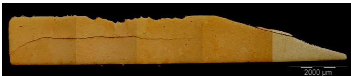
**FIGURE 76 : MICROGRAPHIE OBTENUE APRES ATTAQUE A L'EAU REGALE D'UNE PASTILLE DE POUDRE TAMISEE FRITTEE AVEC UN MONTAGE « QUATRE MURS »**
