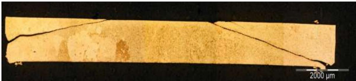
*FIGURE 77 : MICROGRAPHIE OBTENUE APRES ATTAQUE A L'EAU REGALE D'UNE PASTILLE DE POUDRE TAMISEE FRITTEE AVEC UN MONTAGE « SANDWICH »*
