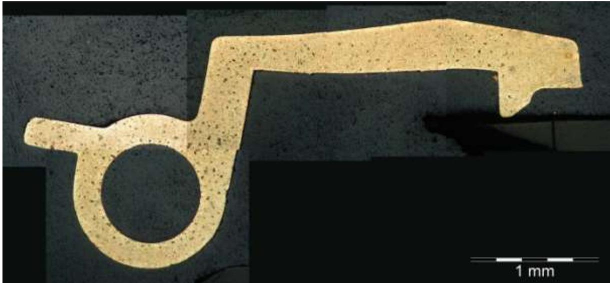
*FIGURE 66 : MICROGRAPHIE OBTENUE APRES ATTAQUE A L'EAU REGALE D'UNE PIECE (POUDRE CLASSIFIEE) FRITTEE SELON LE CYCLE DE REFERENCE COMPLET MAIS SOUS UN DEBIT DE 25ML/S D'HYDROGENE PUR*
