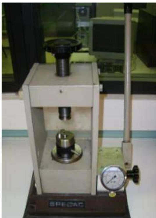
FIGURE 36 : DESCRIPTION DE LA PRESSE UTILISEE POUR REALISER DES PASTILLES
