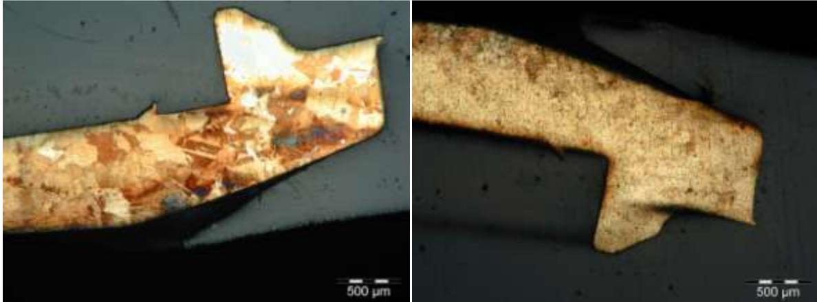
**FIGURE 80 : MICROGRAPHIE OBTENUE APRES ATTAQUE A L'EAU REGALE DE DEUX PIECES L'UNE AVEC POST TRAITEMENT HIP (A GAUCHE) ET L'AUTRE SANS POST TRAITEMENT (A DROITE) ET FRITTEES AVEC LE CYCLE DE REFERENCE**
