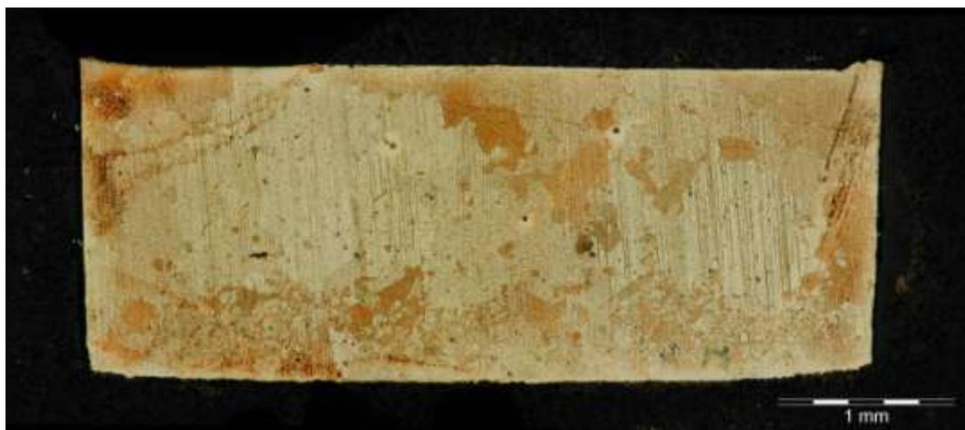
FIGURE 84 : MICROGRAPHIE DE LA PASTILLE OBTENUE SANS AJOUT D'INHIBITEUR DE CROISSANCE GRANULAIRE ET FRITTEE AVEC LE CYCLE DE REFERENCE
