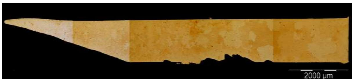
**FIGURE 75 : MICROGRAPHIE OBTENUE APRES ATTAQUE A L'EAU REGALE D'UNE PASTILLE DE POUDRE TAMISEE FRITTEE AVEC UN MONTAGE « SANDWICH »**
