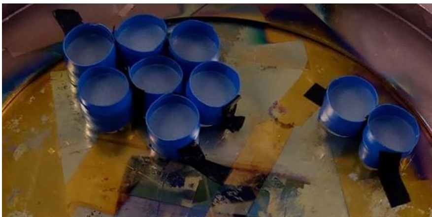
Figure 2.15 : Photo des échantillons de verre entourés de l'adhésif isolant électrique bleu, collés sur le support de la pulvérisation magnétron avec de l'adhésif carbone, pour dépôt d'or à l'IPGG.
