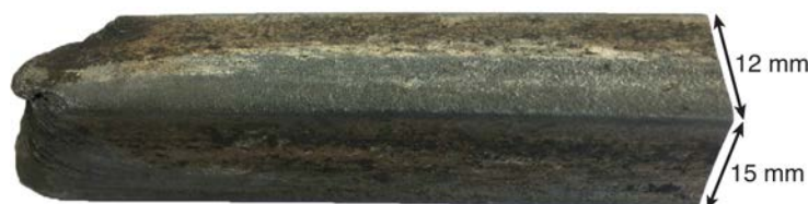
FIGURE III.5 – Photo et dimensions d'une barre de TiZrO.
