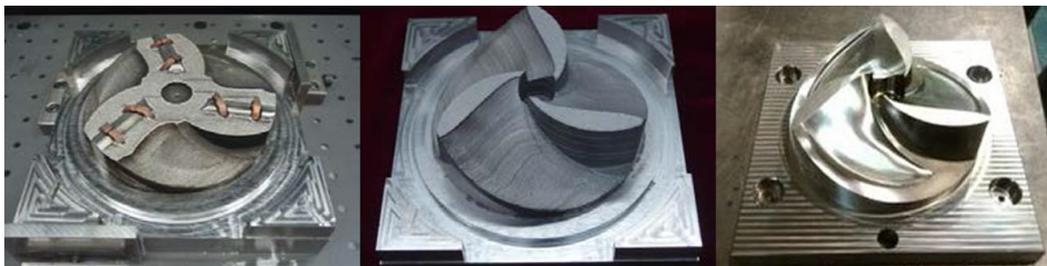
Figure 97 Moule en acier avec un conduit de refroidissement en cuivre encapsulé (Thompson et al., 2016)
