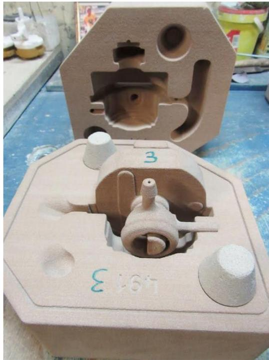
**Figure 8 Moule de fonderie en sable fabriqué en FA<sup>5</sup>**
