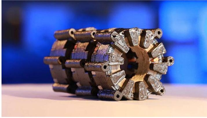
**Figure 102 Corps d'un moteur électrique imprimé à partir de fer, de cuivre et de céramique<sup>17</sup>**
