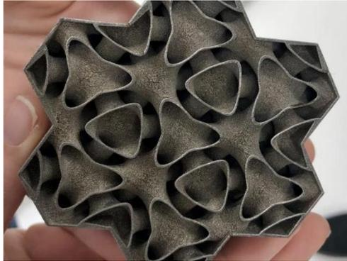
**Figure 98 Echangeur de chaleur imprimé en FA<sup>14</sup>**
