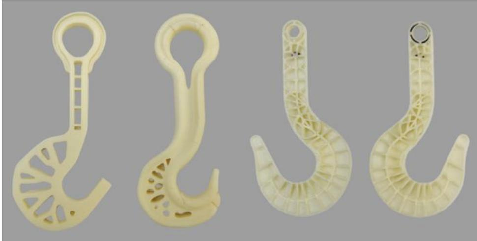
**Figure 82 Modèles 3D des trois concepts de « ROV Hook »**
