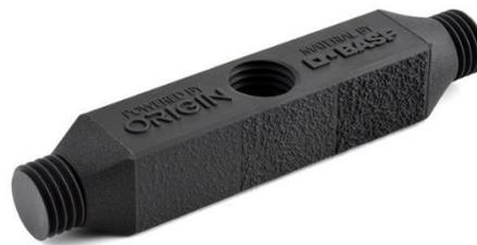
**Figure 92** Echantillon présentant plusieurs niveaux de rugosité<sup>12</sup>
