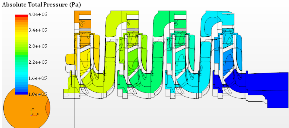
Figure 4-56 Champ de pression totale dans le plan méridien Modèle M3-3 Q_v 35 m 3 /h
