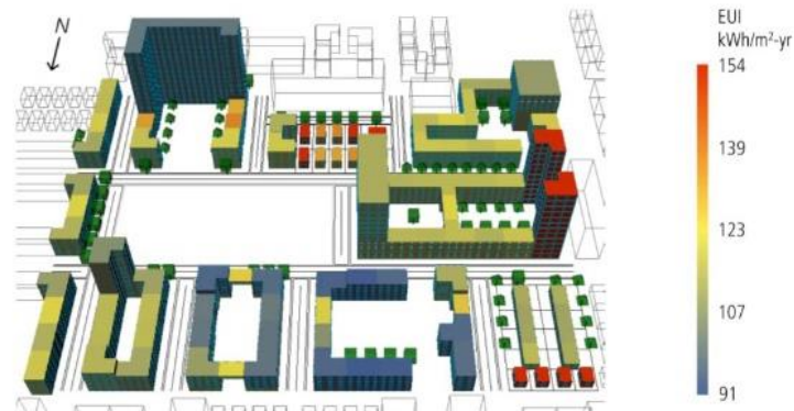
Figure 3-14 : Un exemple de résultats de l'outil UMI visualisés dans Rhinoceros (d'après Reinhart et al., 2013).
