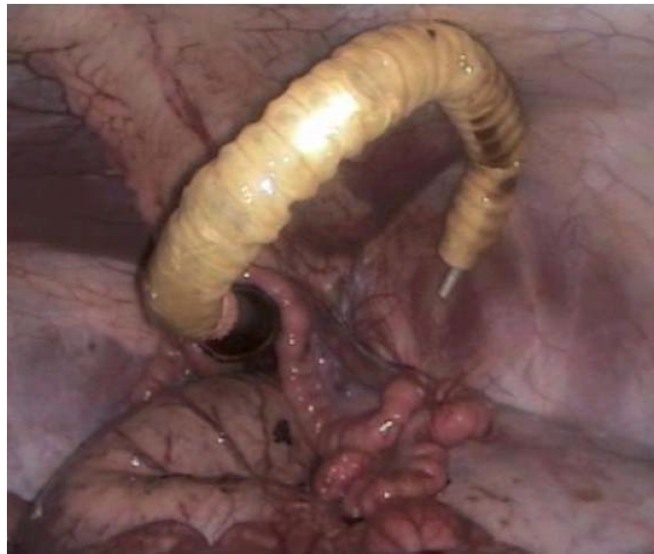
FIGURE 2.9 – Robot endoscopique actionné par micro moteurs [86]
