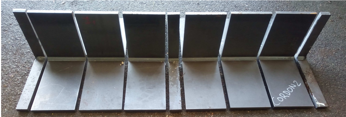
FIGURE II.14: Découpe des structures té symétrique/té asymétrique ; élimination des zones pointées.
