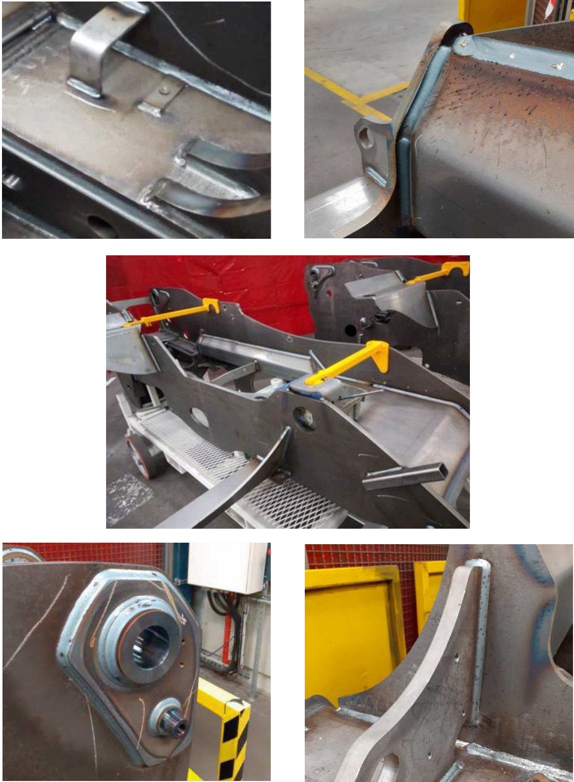
FIGURE 2: Châssis d'engin télescopique brut de soudage ainsi qu'une vue montrant des assemblages soudés représentatifs des structures Manitou.
