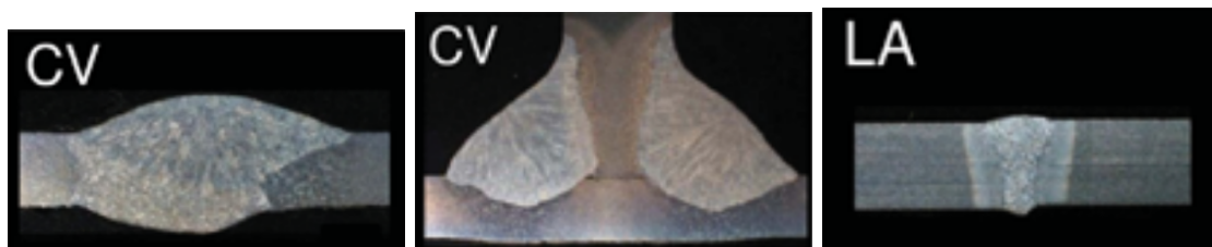
FIGURE I.3: Géométrie du cordon de soudure sur une structure bout à bout et té en fonction du procédé de soudage utilisé, [Remes et Fricke, 2014]
