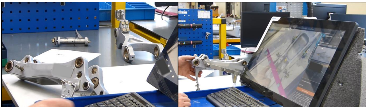
Figure 45 : Illustration de la tâche d'assemblage sélectionnée pour l'évaluation et utilisation d'un poste de travail mobile
