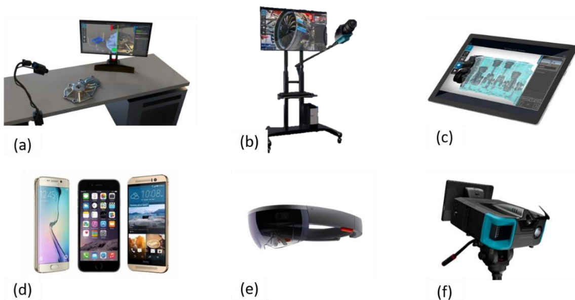
Figure 9 : Exemple de matériels disponibles pour la réalité augmentée de type (a) station fixe, (b) station mobile, (c) tablette, (d) smartphone, (e) casque et (f) projecteur
