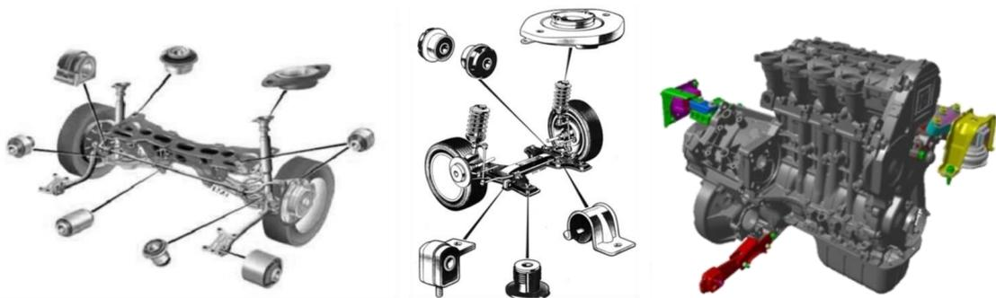
Figure 1: Localisation des articulations élastomères dans les liaisons au sol avant, arrière et dans la suspension GMP.
