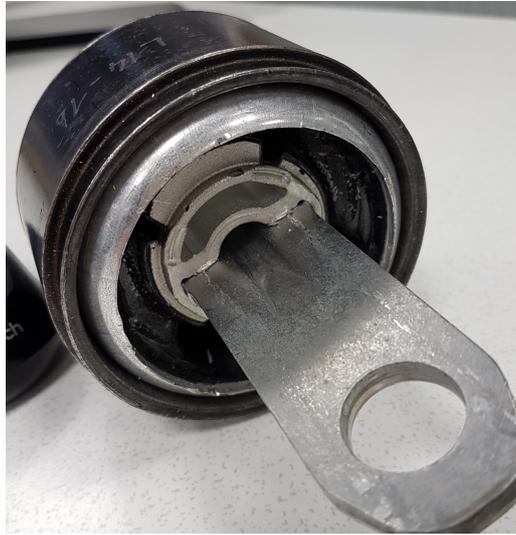
Figure 12: Articulation de traverse déformable.
