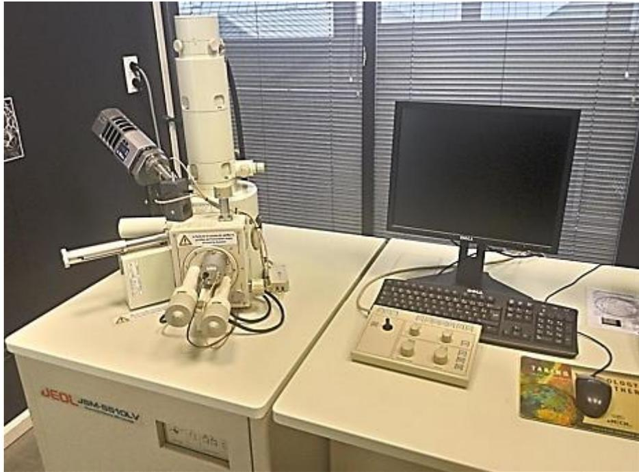
Figure 2.4. Image du microscope électronique à balayage utilisé pour les observations microscopiques
