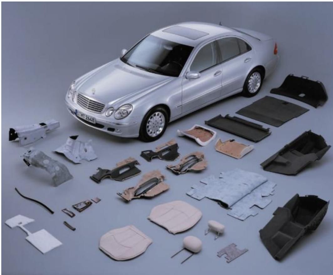
Figure 1.2. Équipements intérieurs de la Mercedes Benz Classe E contenant du lin, du chanvre, du sisal et de la laine [24,30]
