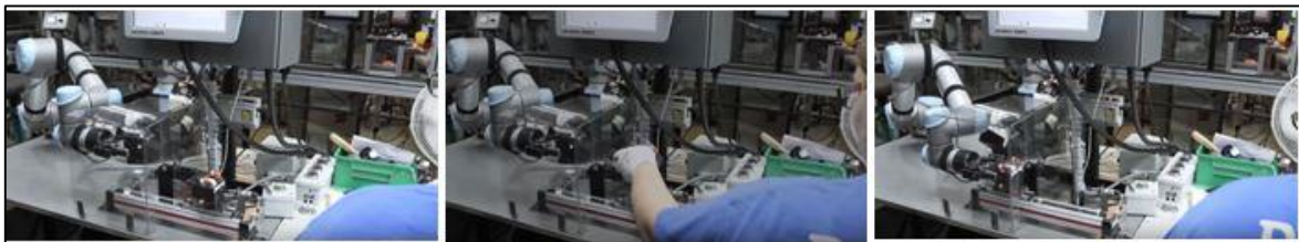
Figure 12. Exemple d'application robotique collaborative "Take and Place" (vidéo: https://youtu.be/oXQxM8fE3c0 )
