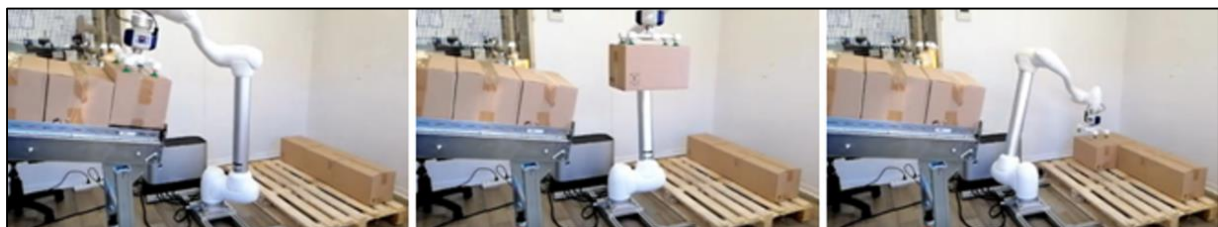
Figure 10. Exemple de solution robotique pour une opération de palettisation (vidéo : https://youtu.be/7OBmVdUAdgk )
