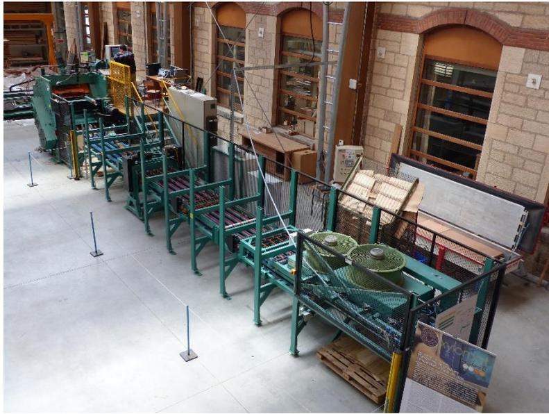
Figure 10 : Dériveuse instrumentée Equipex du LaboMaP
