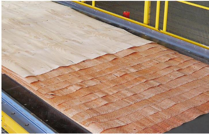
Figure 35. Décalage des placages en amont de la phase de pressage [5]
