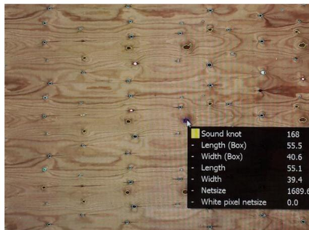
Figure 33. Image de caméra VDA pour l'analyse de défauts visuels [5]
