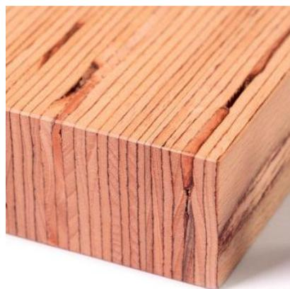
Figure 21. LVL sur chant mettant en évidence la discontinuité de la progression des nœuds à travers les plis créés par le principe de lamellation
