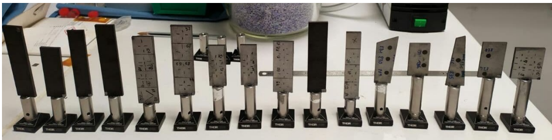
FIGURE 2.23 – Échantillons de CFRP préparés et collés sur leur base magnétiques pour être scannés.
