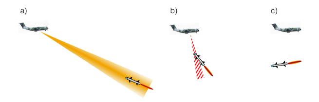
**Figure 7.3:** Scénario de contre-mesure optique. a) Un missile qui traque le point chaud d'un avion est détecté. b) Un fort signal moyen infrarouge est émis depuis l'avion pour brouiller le missile. c) La trajectoire du missile est déviée.
