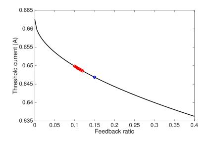
**Figure 7.11:** Réduction du seuil d'un LCQ due à de la réinjection optique après réflexions sur une fibre pour deux séries de mesures, en rouge et en bleu respectivement, et extraction du taux de réinjection associé.
