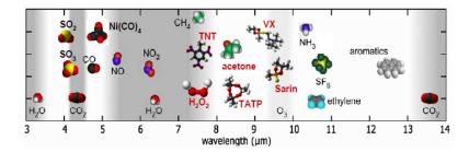
Figure 7.2: Longueur d'onde d'absorption de quelques molécules d'intérêt.
