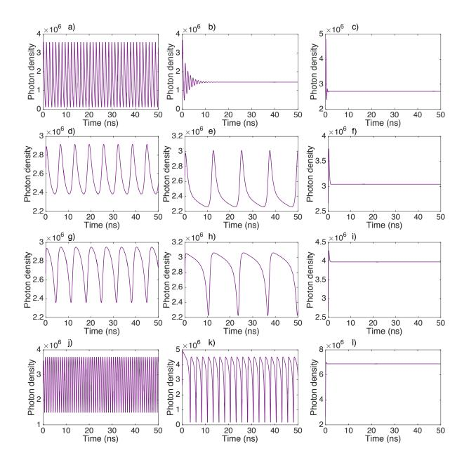
**Figure 7.22:** Traces temporelles numériques pour le LCQ Fabry-Perot soumis à de l'injection optique, avec  $\alpha = 1.5$  and I = 1.25 A. Première ligne :  $\Delta f = +1.05$  GHz et a) K = -14 dB, b) K = -13 dB, c) K = -6 dB. Deuxième ligne :  $\Delta f = +0.2$  GHz et d) K = -30 dB, e) K = -27 dB, f) K = -15 dB. Troisième ligne :  $\Delta f = -0.2$  GHz et d) K = -29 dB, e) K = -26 dB, f) K = -12 dB. Quatrième ligne :  $\Delta f = -1.2$  GHz et d) K = -15 dB, e) K = -8 dB, f) K = -2 dB.
