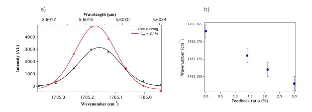
**Figure 7.7:** Evolution de la longueur d'onde du LCQ sous réinjection optique. a) Spectres optiques et fits gaussiens du LCQ sans réinjection et avec faible réinjection  $f_{ext} = 2.1\%$ . b) Décalage en longueur d'onde en fonction du taux de réinjection.
