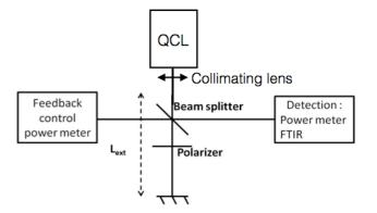
Figure 7.5: Schéma du montage expérimental de réinjection dans les LCQ.
