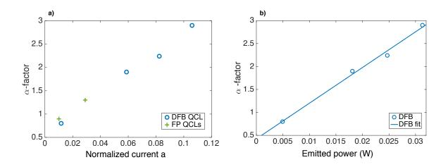
**Figure 7.9:** a) Evolution du facteur  $\alpha$  en fonction du courant de pompe normalisé, et comparaison entre les deux méthodes à 10°C. b) Evolution du facteur  $\alpha$  en fonction de la puissance optique émise par le LCQ DFB.
