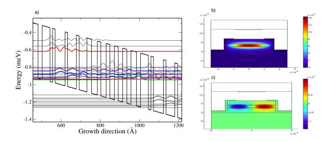
**Figure 7.6:** a) Fonctions d'onde de la structure LCQ étudiée, simulées avec METIS. En rouge, niveau  $|3\rangle$  de deux périodes consécutives, en violet niveau  $|2\rangle$ , en bleu niveau  $|1\rangle$ , divisé en deux états phonons, en vert état de l'injecteur. b) Simulation de modes au premier ordre avec COMSOL. c) Simulation de modes au second ordre.
