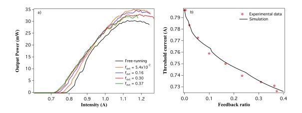
**Figure 7.10:** Effet de la réinjection optique sur la P(I) du LCQ Fabry-Perot de 4 mm  $\times$  6  $\mu$ m. a) P(I) à différents taux de réinjection, avec une cavité externe de 15 cm. b) Diminution du seuil expérimentale et numérique en fonction du taux de réinjection.
