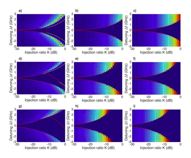
**Figure 7.21:** Simulations numériques superposées aux résultats analytiques (rouge pour Saddle-Node et jaune pour Hopf) pour le LCQ Fabry-Perot soumis à de l'injection optique. Première ligne :  $\alpha = 0$  et a) I = 1.25 A, b) I = 1.5 A, c) I = 2 A. Deuxième ligne :  $\alpha = 1.5$  et d) I = 1.25 A, e) I = 1.5 A, f) I = 2 A. Troisième ligne :  $\alpha = 3$  et g) I = 1.25 A, h) I = 1.5 A, i) I = 2 A.
