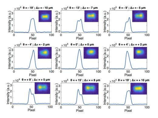
Figure 7.19: Effet de la réinjection optique sur un LCQ de 14  $\mu$ m de large qui présente un fort beam steering.
