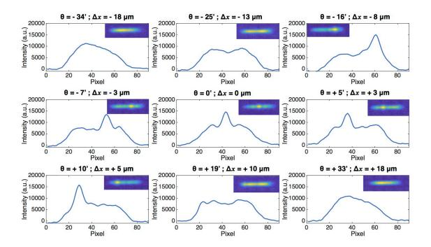
**Figure 7.17:** Profils de champs proches à la facette du LCQ pour différents angles de réinjection, exprimés à la fois en minutes d'arc et en déplacement sur la facette en fonction de la position centrale. Les courbes en insert correspondent aux champs proches enregistrés sur la caméra.
