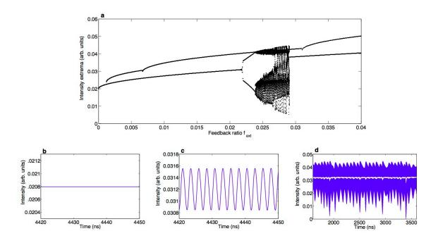
**Figure 7.16:** Diagramme de bifurcation numérique pour P = 0.02 et  $L_{ext} = 35$  cm, et traces temporelles associées. a) Diagramme de bifurcation numérique. b) Trace temporelle pour  $f_{ext} = 0.11\%$ , montrant un signal stable. c) Trace temporelle pour  $f_{ext} = 2.14\%$ , montrant des oscillations à la fréquence de cavité externe. d) Trace temporelle pour  $f_{ext} = 2.59\%$ , montrant des oscillations à la fréquence de cavité externe et des LFF.
