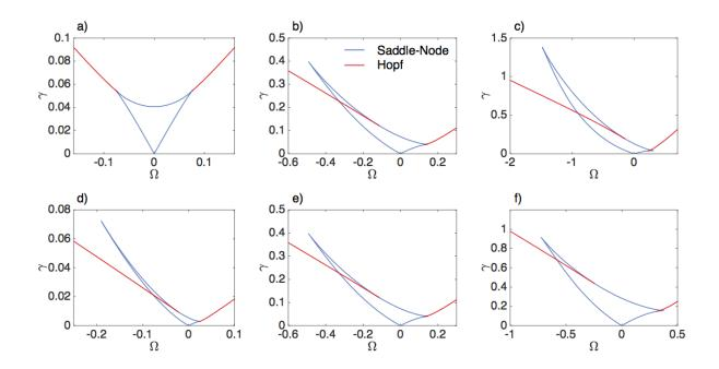
**Figure 7.20:** Simulations analytiques pour un LCQ Fabry-Perot soumis à de l'injection optique. Première ligne: courant de pompe constant I = 1.5 A et a)  $\alpha = 0$ , b)  $\alpha = 1.5$  and c)  $\alpha = 3$ . Deuxième ligne:  $\alpha = 1.5$  fixé et d) I = 1.25 A, e) I = 1.5 A, f) I = 2 A.
