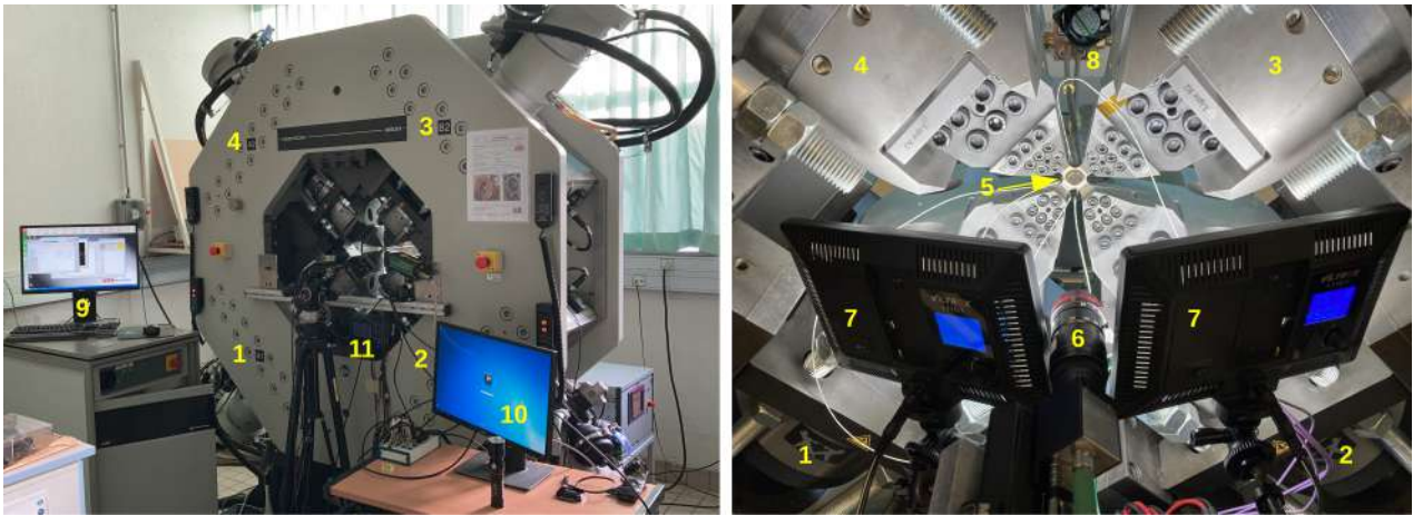
FIGURE 2.19 – Dispositif expérimental pour les essais biaxiaux. Les chiffres indiqués en jaune correspondent aux éléments expérimentaux décrits dans le paragraphe ci-dessus.
