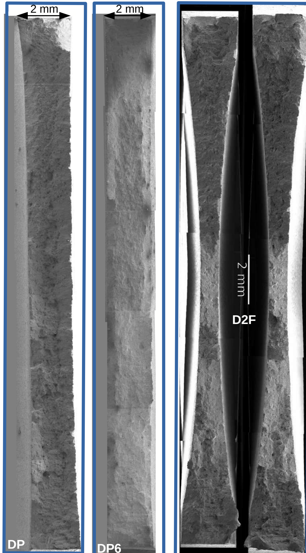
FIGURE 4.13 – Faciès de rupture obtenus par observations MEB sur les éprouvettes DP-DP6-D2F sollicitées à 20°C.
