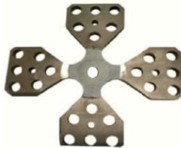
FIGURE 2.8 – Exemple d’éprouvette biaxiale classique utilisée dans le cadre de caractérisation en fatigue thermo-mécanique. La largeur de l’éprouvette est de 20 cm.
