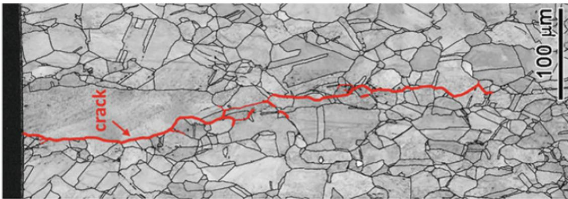
**FIGURE 25** – Amorçage de CSC au niveau d'un grain allongé et propagation le long de ce joint de grain. L'échantillon est un A600MA, milieu primaire simulé à 360 ° C et 25  $mLH_2/kgH_2O$  d'hydrogène dissous - [119].
