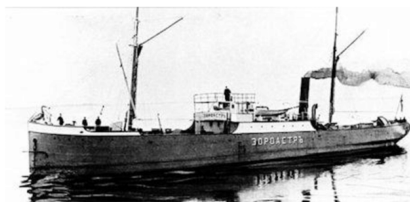
Figure 2.1: Photographie du Zoroaster [25], premier pétrolier. longueur: 54 m, capacité: 240 tonnes
