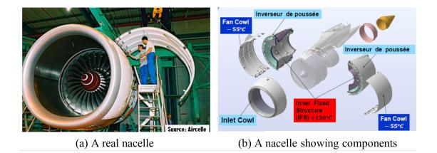
Figure B.1 – Image d'une nacelle d'Airbus A380 [3].
