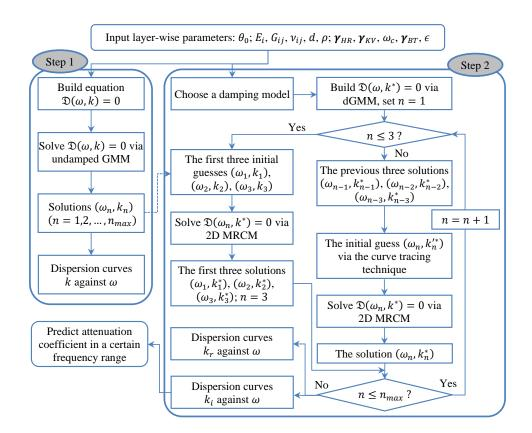
Figure B.11 – L'organigramme de l'algorithme dGMM en deux étapes pour résoudre le DE complexe. estimer ces paramètres au sens des moindres carrés. Les coefficients d'atténuation identifiés expérimentalement avec la dGMM permettent d'obtenir un bon accord entre le calcul théorique et l'identification
