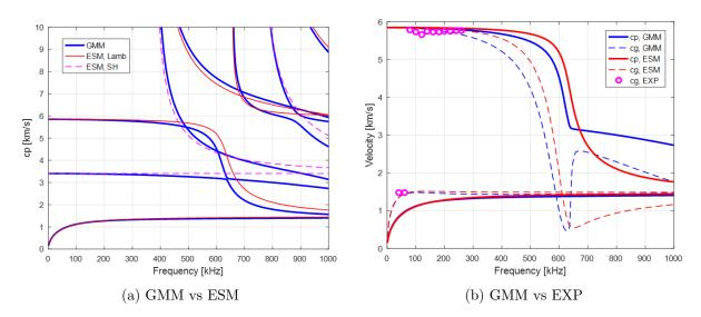
Figure B.5 – Courbes de dispersion des ondes guidées ouvertes à l'angle de propagation  $\theta = 0^{\circ}$  calculées via GMM et ESM.
