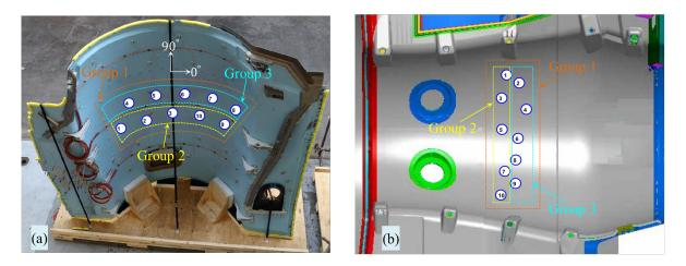
Figure B.13 – Le réseau de PZTs pour l'IFS: (a) le cas ou la structure n'est pas montée sur l'A380 et (b) le cas ou la structure est montée sur un A380 instrumenté.
