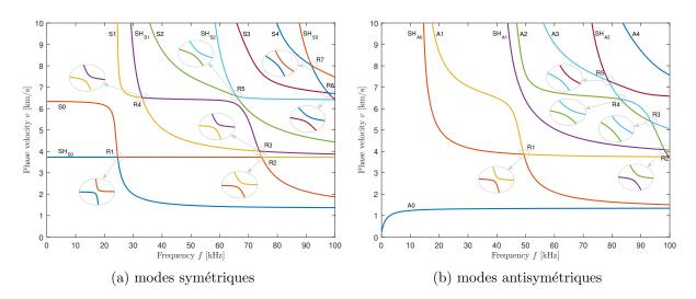
Figure B.6 – Courbes de dispersion du stratifié aérospatial à 400 couches dans la direction  $\theta = 0^{\circ}$ .
