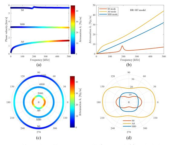
Figure B.14 – Prédiction du modèle HR + BT pour l'IFS non monté: (a) courbe de dispersion de la vitesse de phase à  $\theta = 90^{\circ}$ , (b) courbe de dispersion du coefficient d'atténuation à  $\theta = 90^{\circ}$ , (c) tracé polaire de la vitesse de phase [m/s] à f = 200 kHz, (d) tracé polaire du coefficient d'atténuation [Np/m] à f = 200 kHz.
