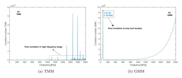
Figure B.10 – Le nombre de conditionnement des matrices pour le cas Open Guided Waves à  $v_0 = 1000 \text{ m/s}$  pour (a) la matrice de transfert de monodromie  $\mathbf{T}^{\text{mono}}$  (méthode TMM) et (b) la matrice globale  $\mathbf{D}_G$  (méthode GMM).
