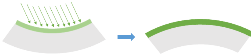
Figure 4.32 : Illustration de l'effet du traitement sur la courbure des puces
