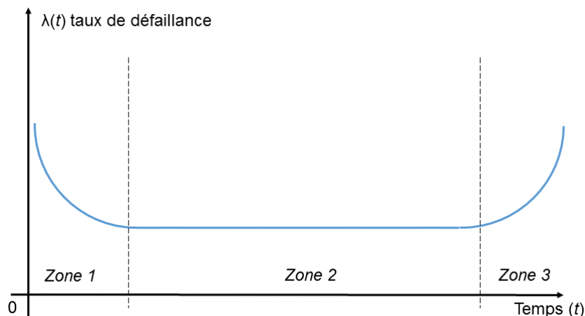
Figure 1.5 : Courbe de variation du taux de défaillance des équipements électroniques
