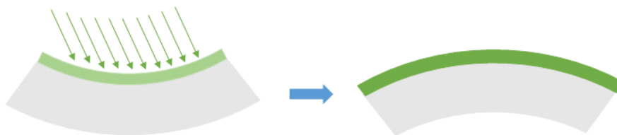
Figure 4.32 : Illustration de l'effet du traitement sur la courbure des puces
