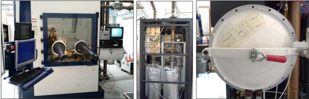
**Figure III-1 : Optomec LENS 850R (à gauche), circuit de régénération (au milieu), sas (à droite)**
