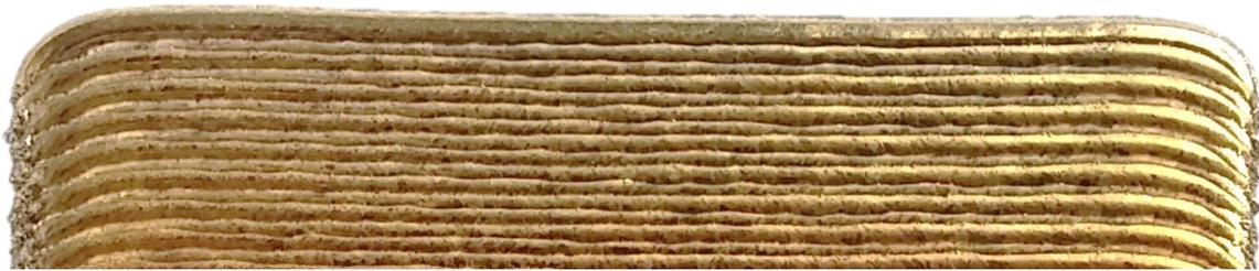
Figure V-9 : Ménisques d'un mur en paramétrie **B** (P1245 V500 Dm10) long de 80 mm
