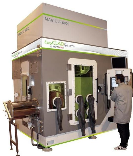
**Figure I-2 : Machine de DLD « MAGIC LF6000 » conçue par Irepa Laser dans le cadre du projet FALAFEL**
