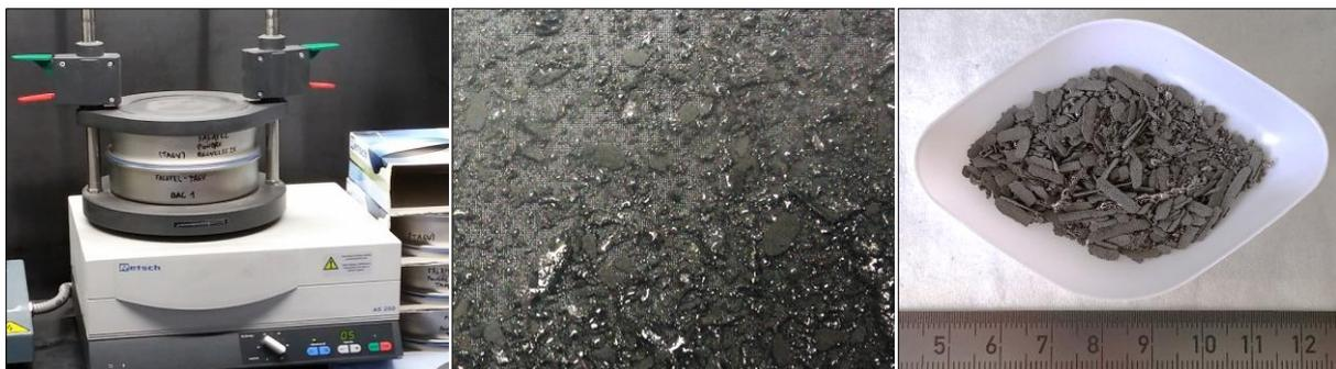
**Figure VI-11 : Tamiseuse (à gauche), zoom dans le tamis de 90 µm (au milieu) et refus de tamisage récupéré (à droite)**
