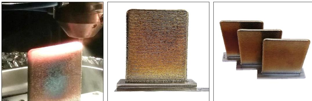
**Figure VI-3 : Murs monocordons destinés aux essais de traction des différents niveaux de recyclage de la poudre de TA6V**
