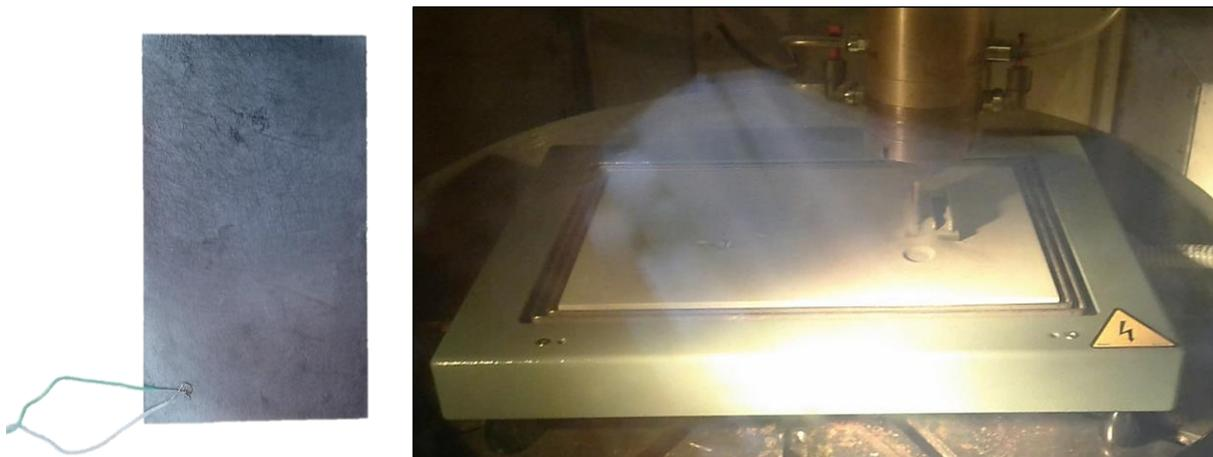
**Figure III-11 : Dispositif d'étude du préchauffage : construction d'un mur monocordon de 50 couches sur un substrat en TA6V d'épaisseur 5 mm instrumenté (à gauche) placé sur une plaque chauffante régulée à une consigne de température fixe (à droite)**
