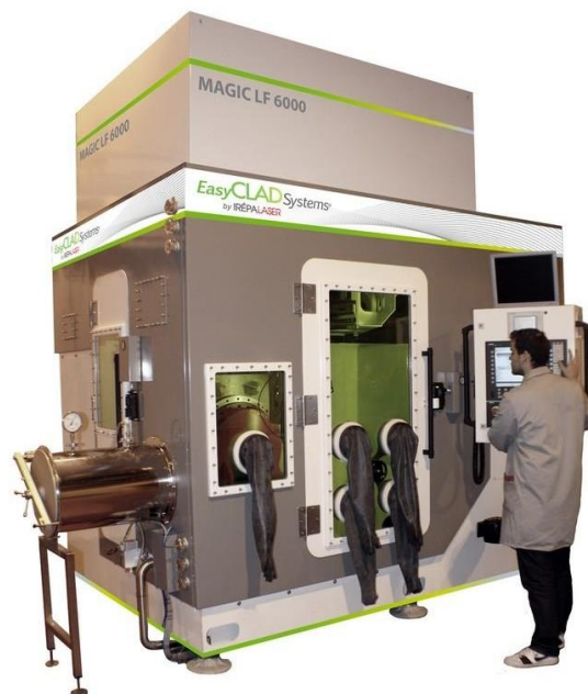
Figure I-2 : Machine de DLD « MAGIC LF6000 » conçue par Irepa Laser dans le cadre du projet FALAFEL (Irepa Laser, 2015)
