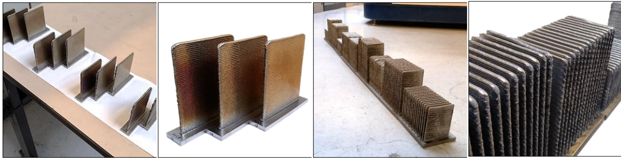
A) Séries de 3 murs monocordons construits dans le premier cycle de chaque séquence B) Détail : murs pour caractérisation mécanique issus de la séquence 1 C) « Multimurs » = séries de 15 murs monocordons juxtaposés sur un même substrat D) Détail : multimurs pour récupérer de la poudre non consolidée
