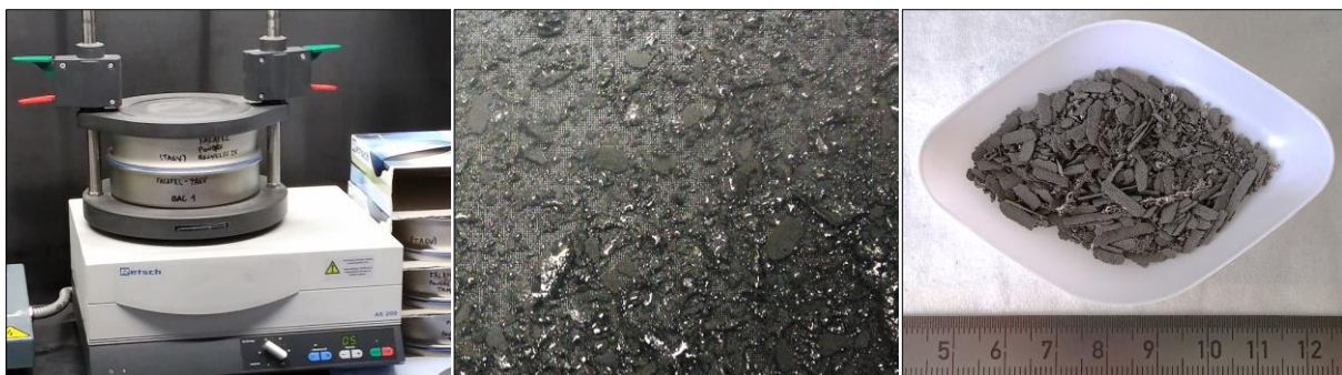
Figure VI-11 : Tamiseuse (à gauche), zoom dans le tamis de 90 µm (au milieu) et refus de tamisage récupéré (à droite)
