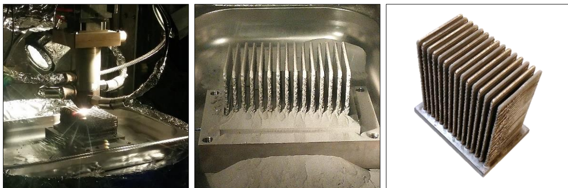
Figure VI-5 : Multimurs monocordons destinés à la récupération de poudre pour alimenter les séquences suivantes de l'étude
