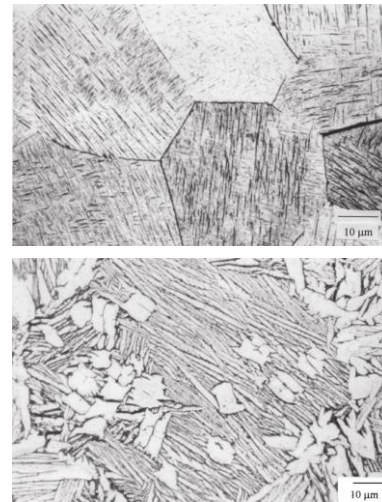
Figure VII-5 : Phase martensitique \alpha' dans des ex-grains \beta équiaxes (en haut) - formation de la phase \alpha dans la matrice \beta (en bas) d'après (Gil, et al., 2001)
