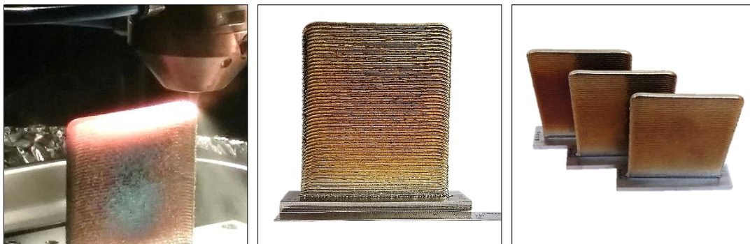
Figure VI-3 : Murs monocordons destinés aux essais de traction des différents niveaux de recyclage de la poudre de TA6V
