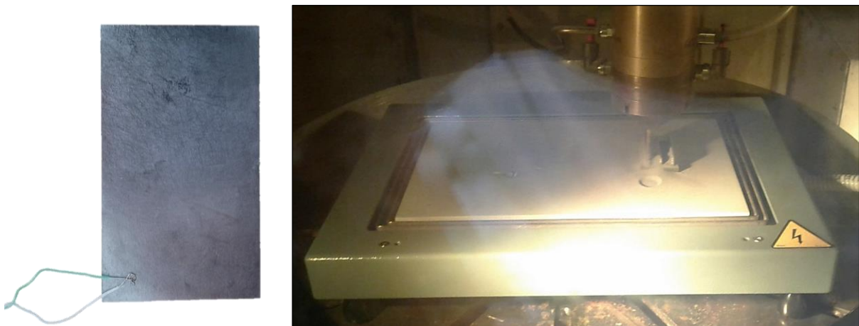
Figure III-11 : Dispositif d'étude du préchauffage : construction d'un mur monocordon de 50 couches sur un substrat en TA6V d'épaisseur 5 mm instrumenté (à gauche) placé sur une plaque chauffante régulée à une consigne de température fixe (à droite)
