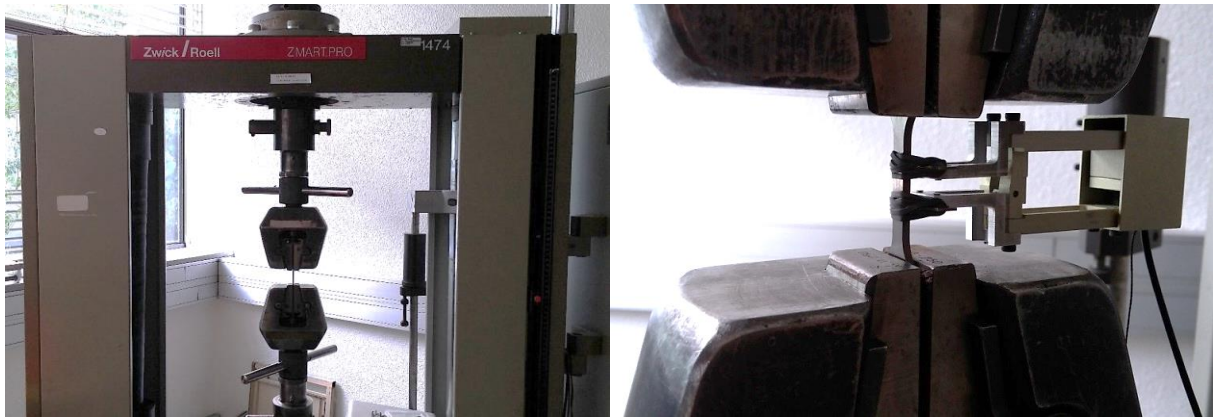
Figure VII-7 : Essais de traction sur machine Zwick/Roell avec suivi de l'allongement par extensomètre à couteaux
