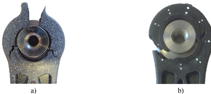
Figure 10-11 Faciès de rupture de la bielle a) rupture dans la zone de recollement de la matière injectée b) rupture dans la zone de sur contrainte montrée par le calcul numérique.
