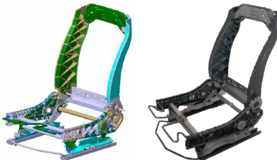
Figure 9-1 Siège automobile du projet DEMOS, en structure multi-matériaux [Dossier Faurecia].
