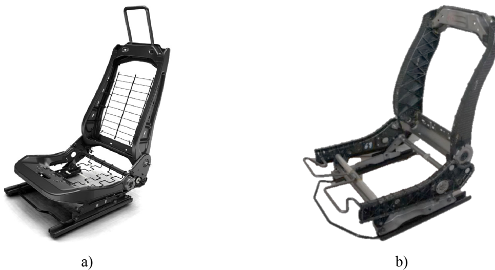
Figure 1-3 a) Siège automobile en acier à haute limite élastique. b) Siège automobile du projet DEMOS en multi-matériaux avec matériaux composites [Dossier Faurecia].
