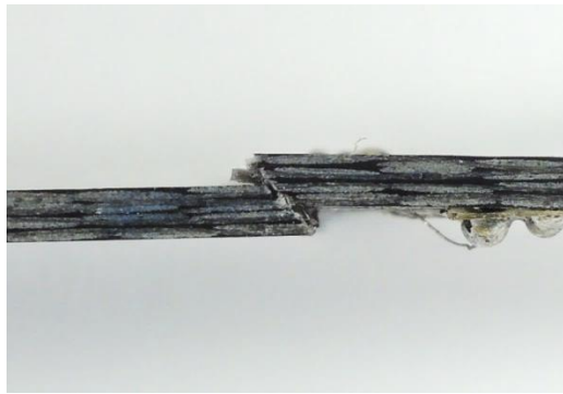
a) Contrainte à rupture environ 272 MPa
