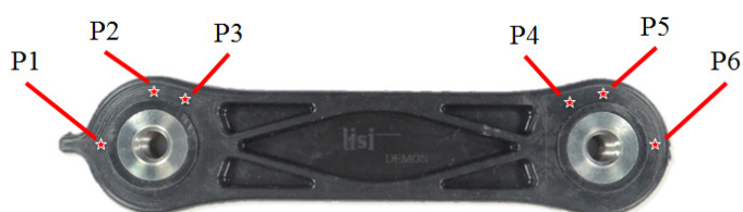
Figure 10-8 Points d'observation, où les déplacements ont été obtenus par corrélation d'images numériques.
