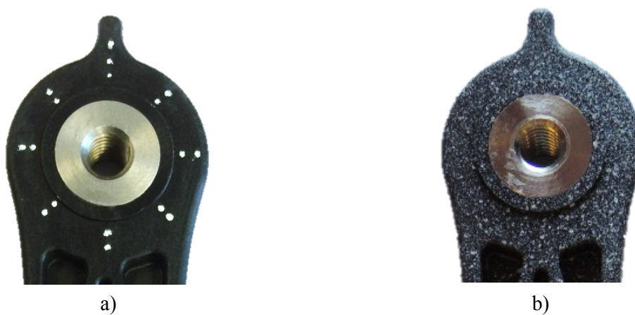
Figure 10-5 Déformation autour de l'insert métallique mesurée à l'aide de la corrélation d'images numériques a) en suivant les points blancs b) en utilisant un mouchetis.
