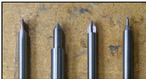
Figure 9-5 Différents types de broche de perçage utilisés, pour fabriquer différentes configurations d'éprouvette trouée.
