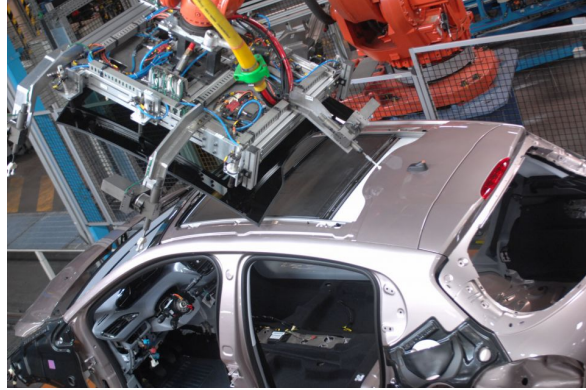
Figure 1-6 Les parties vitrées fixes de la Peugeot 208 sont collées sur la carrosserie par des robots agissant avec grande précision [Dossier PSA Peugeot].
