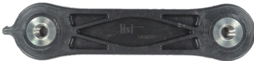
**Figure 10-1** Bielle en composite injecté PA66 GF50, avec 2 inserts métalliques au niveau des fixations.
