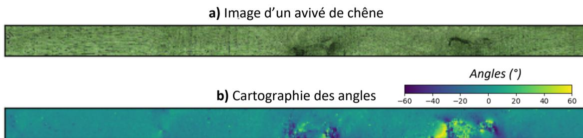
Figure 2.3 : Exemple d'une cartographie des mesures locales d'ODF d'un avivé de chêne.
