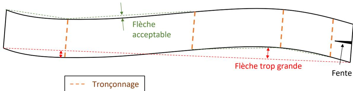
Figure 1.17 : Exemple de purge d'une fente et de segmentation d'un avivé trop déformé en courçons de plus faible flèche.
