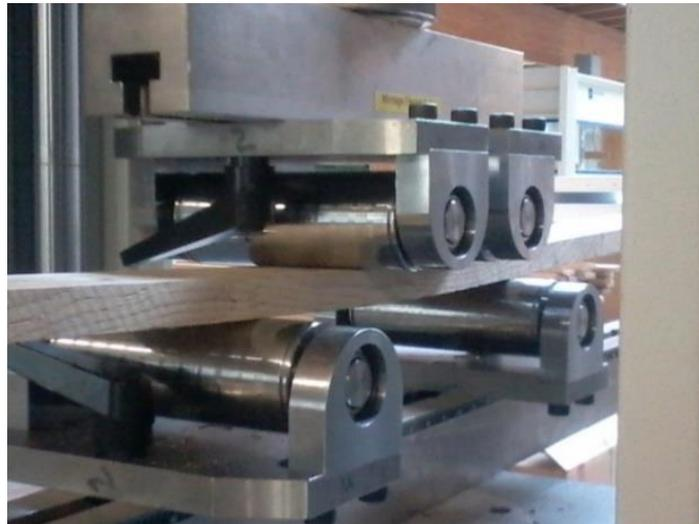
Figure 4.2 : Photo du dispositif d'essai de mesure de la résistance en flexion à plat des aboutages à enture multiples (montage d'essai selon EN408:2012)
