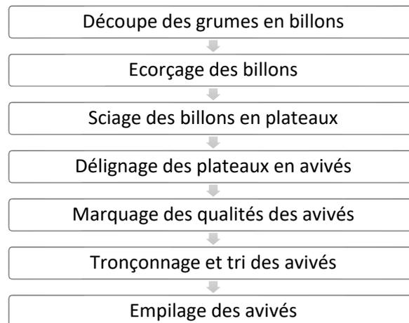
Figure 1.8 : Liste des opérations de 1<sup>ère</sup> transformation dans le processus de fabrication de lames aboutées.
