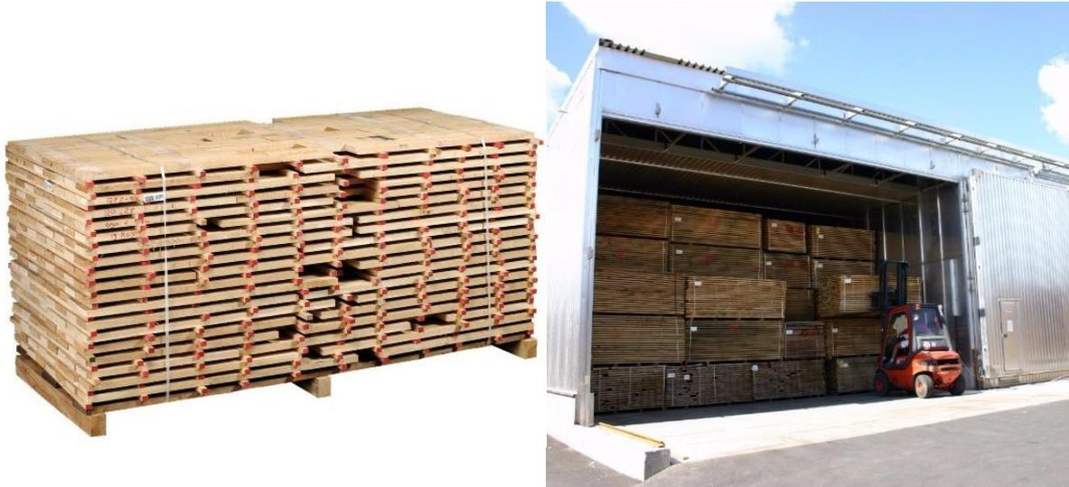
Figure 1.13 : Pile d'avivés (gauche) et chargement de piles dans un séchoir (droite). (Crédit : Ducerf).
