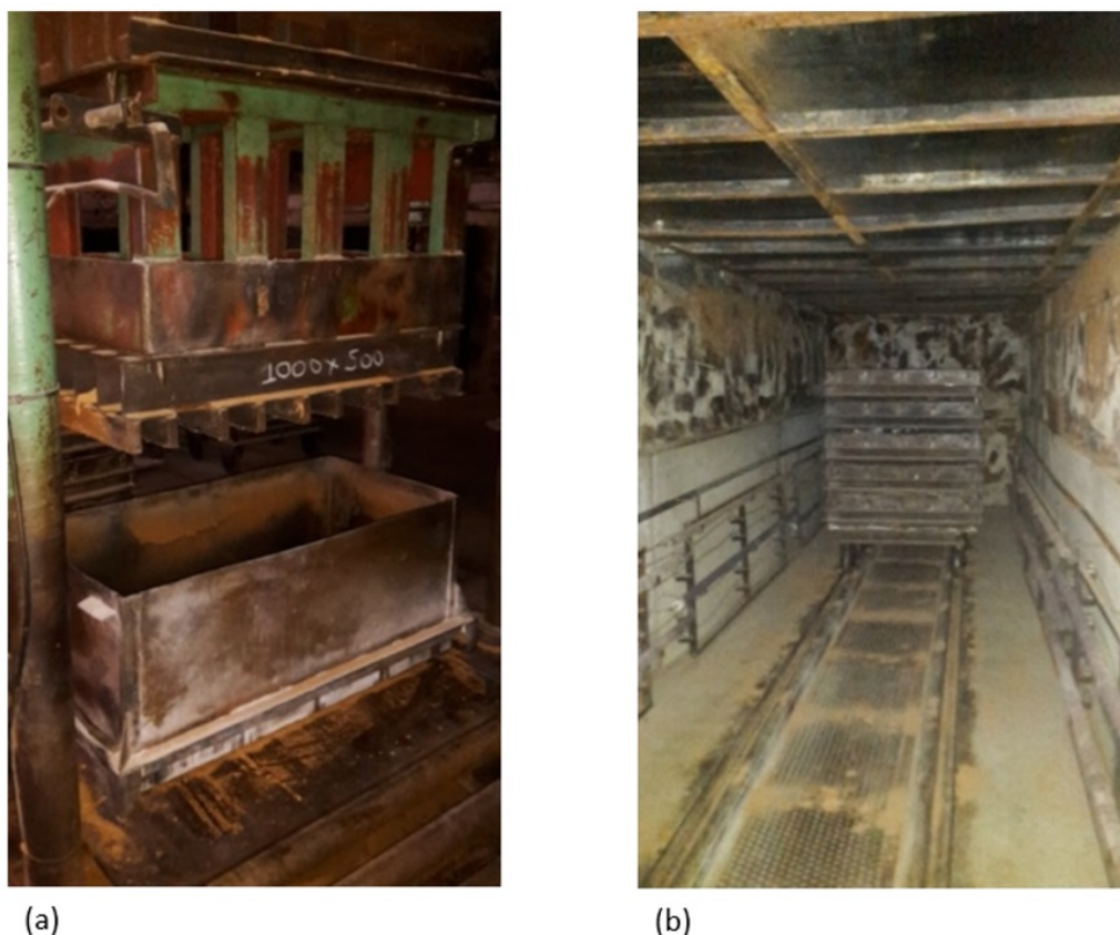
Figure 1.14: Phase de compression du mélange dans le moule (a) et étuve pour la polymérisation de la résine (b) (photos prises à l'intérieur de l'usine Lièges HPK).
