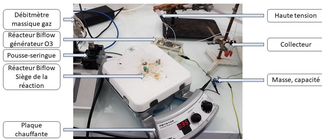
Figure 0-26 - Montage utilisé pour simuler une arrivée d'ozone dans le réacteur biphasique.
