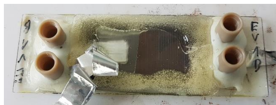
Figure 0-17 - Réacteur à isolation NOA renforcé par de la poudre de silice sur les bords.
