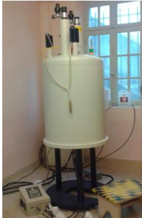
**Figure 54 :** Spectromètre vertical à 7 T, Plateforme IRM ENSCP, PIV, LIOPA.
