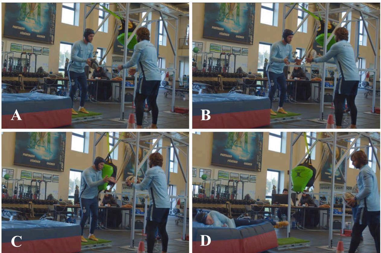
Figure 57. Illustration du protocole expérimental. **A** : début des acquisitions et échange de passes avec l'expérimentateur ; **B** : déclenchement manuel de l'impacteur ; **C** : impact ; **D** : chute du participant sur le tapis.
