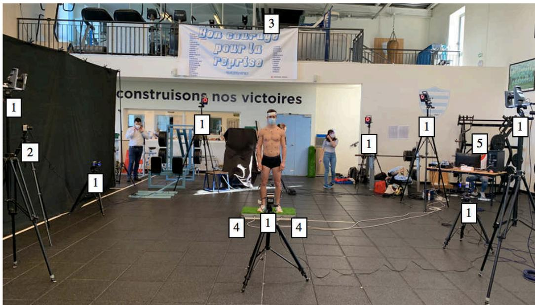
Figure 18. Dispositif d'analyse du mouvement installé dans la salle de musculation du Racing 92. 1 : caméras optoélectroniques ; 2 : caméra optique ; 3 : caméra sport ; 4 : plateformes de force et 5 : zone d'acquisition des données.
