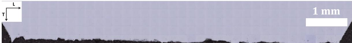
Figure 205 : Cartographie optique de la rupture d'une éprouvette EU1, 0,3%C High Ti, traitement 900°C-7min
