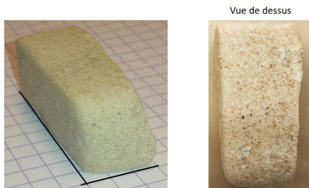
Figure 5.4 – Surface d'un bloc de gypse saccharoïde ( $4 \times 2 \times 1,2 \text{ cm}^3$ ) après 7 jours d'immersion ( $v \approx 10^{-2} \text{ m.s}^{-1}$ )
