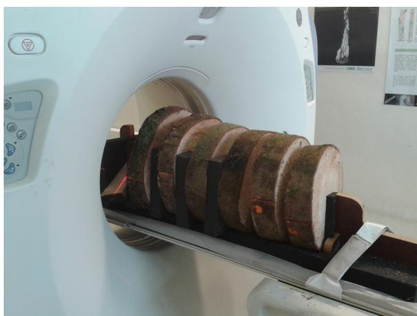
**FIGURE 3.6** – Rondelles de tronc lors d'un passage au tomographe.
