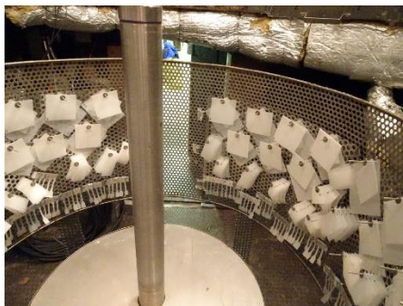
Figure 56. Arrangement des échantillons dans la chambre d'irradiation [2].
